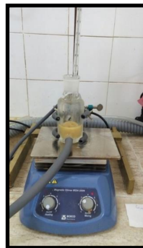
Фиг. 4.1. Схема на опитната постановка за изследване на диаграмата на разтворимост 1-термостат, 2-реактор с термостативно стъкло, 3-механична бъркалка
