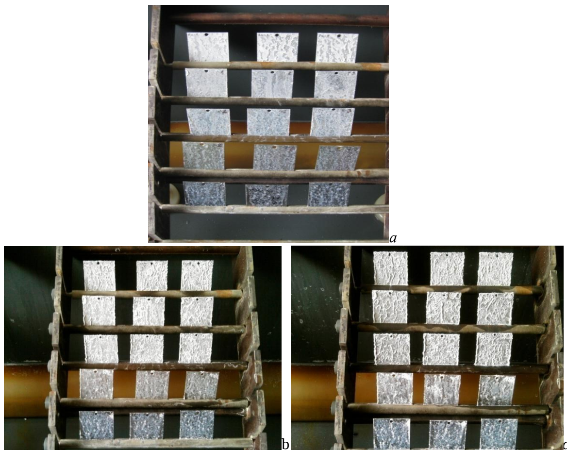
Фиг. 4.1.23. Състояние на повърхността на образците по време на изпитанието в NSS: а- на 24-я час /1-ви цикъл/; б- на 96-я час /4-ти цикъл/; с- на 192-я час /8-ми цикъл/
