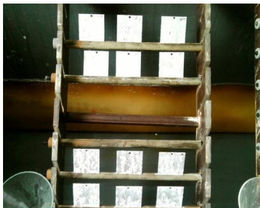
Фиг. 4.2.22. Състояние на повърхността на образците по време на изпитването в NSS: а-на 24-я час /1-ви цикъл/; б- на 96-я час /4-ти цикъл/; с- на 192-я час /8-ми цикъл/
