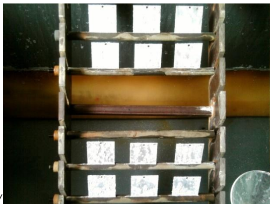
Фиг. 4.2.22. Състояние на повърхността на образците по време на изпитването в NSS: а-на 24-я час /1-ви цикъл/; б- на 96-я час /4-ти цикъл/; с- на 192-я час /8-ми цикъл/
