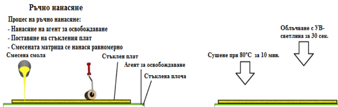
Фигура 3. Технологичен метод за изготвяне на стъклопластите
