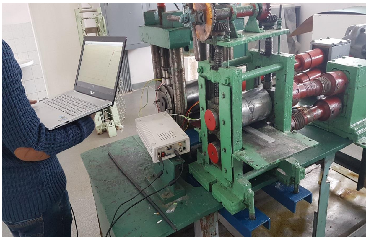
Фиг.5 – Измерение на усилията при ко-процеса „валцуване-РКЪпресуване“
