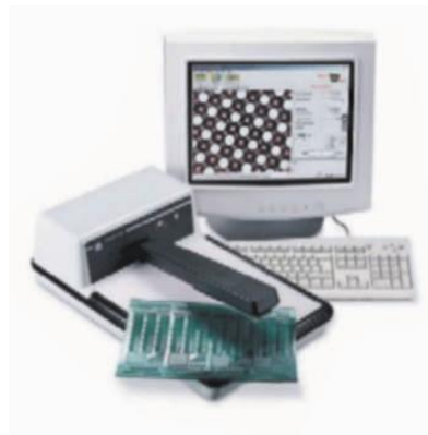
Фиг. 1. Устройство за измерване характеристиките на печатната форма VIPflex 333
