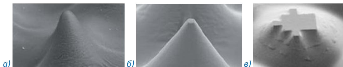
Фиг. 26. Микрофотографии на растерови елементи, а) получени по класическата технология за изработване на цифрови фотополимерни форми, б) в контролирана атмосфера и в) по технологията FTD с ламиниране на предварително гравирани филм.
