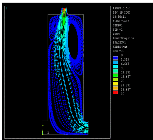
Фигура 44: Илюстрация на движението на потока във физическия модел
