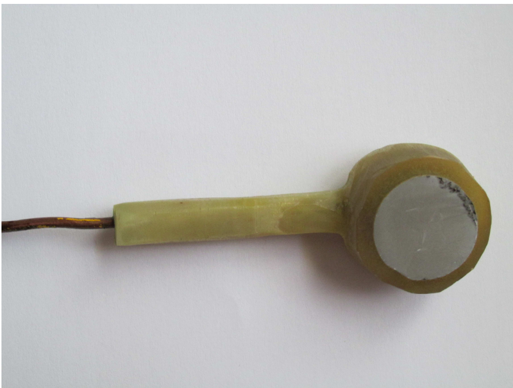
Фиг. 1 Обемен електрод, използван за изследване на получаването на анодни филми.
