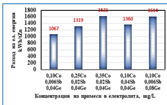
Фиг.7.14. Влияние на концентрацията на примеси от Co, Sb и Ge в промишлени електролити върху коефициента на използване на тока и разхода на електроенергия
