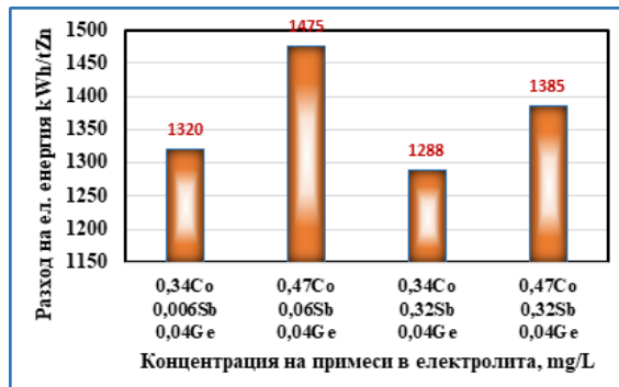
Фиг.7.15. Влияние на завишените концентрации на Co и Sb в промишлени електролити върху коефициента на използване на тока и разхода на електроенергия
