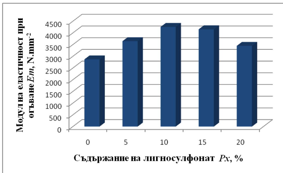
Фигура 11. Изменение на модула на еластичност на MDF, в зависимост от съдържанието на калциев лигносулфонат.
