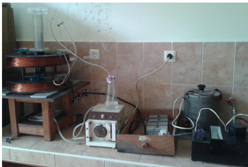
Фигура 1. Снимка лаб. инсталация с магнитна система за изследване на биопроцеси
