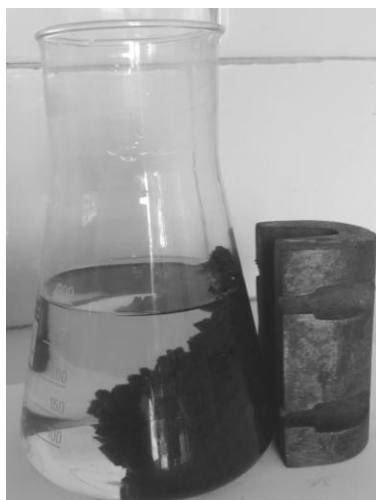
Фигура 7. Сепариране на магнитни носители под действие на постоянно магнитно поле.
