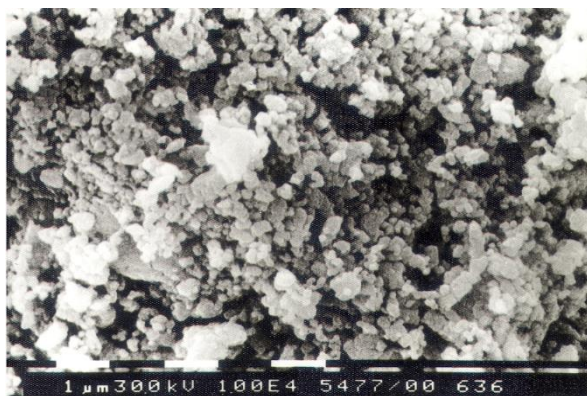
Фиг. 16. СЕМ микрография на \text{LiMn}_2\text{O}_4 синтезиран по твърдофазен метод при температура 700^\circ\text{C} за 18 часа.
