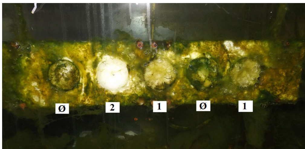
Фиг. 11 Обрастване след пет месеца престой в черноморски аквариум. Ø-контрола (с 6 мас.% стандартен омрежител ES40); 1- образец с 6 мас.% ПЕГ-силан; 2- образец с 2 мас.% ПЕГ-силан + 4 мас.% ES40.
