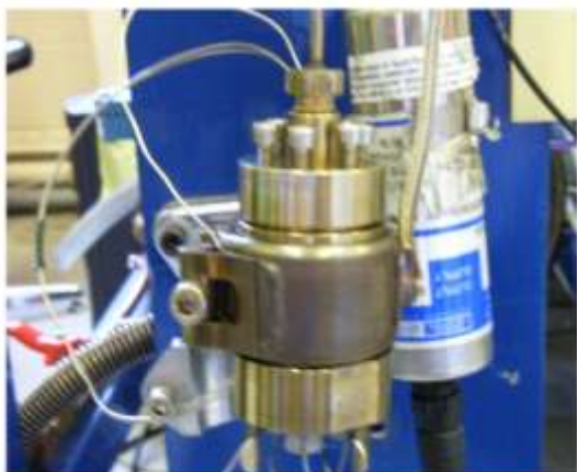
Фиг.4(2.28): Общ вид на микро-резервоара за съхранение както и вътрешно разположение на термодвойките
