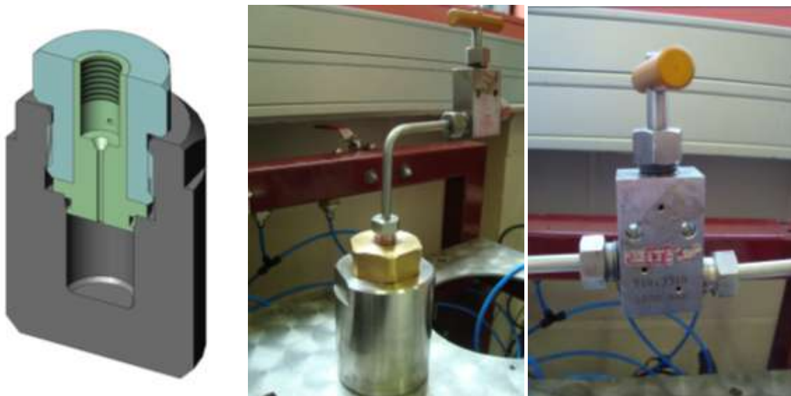
Фиг.2(2.7) : Общ вид на клетката за адсорбция и вентила SITEC
