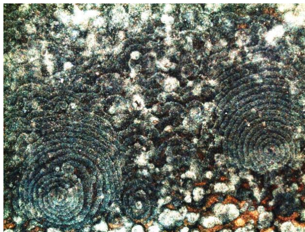
Фигура 14. Оптични изображения на спирални структури на покрития от сплав Ag-Sn. Съставът на електролита е Ag-5; Sn-50; K_4P_2O_7 -280, KSCN-60. Ширината на изображението е 2 mm.
