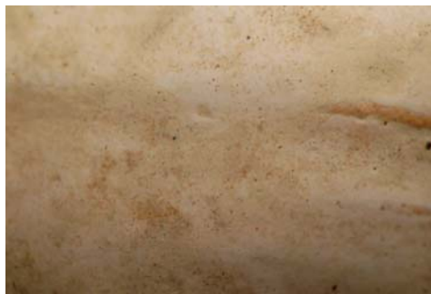
Фиг.11. Микроскопска снимка на бяло каолиново покритие, увеличение 50X.
