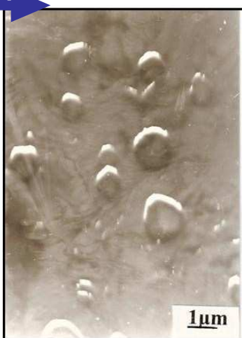
Фигура 34. ТЕМ микрографии на: а) горен слой на образец със състав 60\text{B}_2\text{O}_3.10\text{MoO}_3.30\text{CoO} , б) долен слой; в) образец със състав 30\text{B}_2\text{O}_3.10\text{MoO}_3.60\text{CoO}
