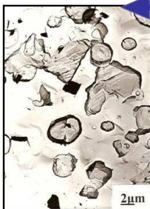
Фигура 35. ТЕМ микрографии на долен слой на образци със състави: а), б) 40\text{B}_2\text{O}_3.20\text{MoO}_3.40\text{CoO} ; в), г) 30\text{B}_2\text{O}_3.30\text{MoO}_3.40\text{CoO}
