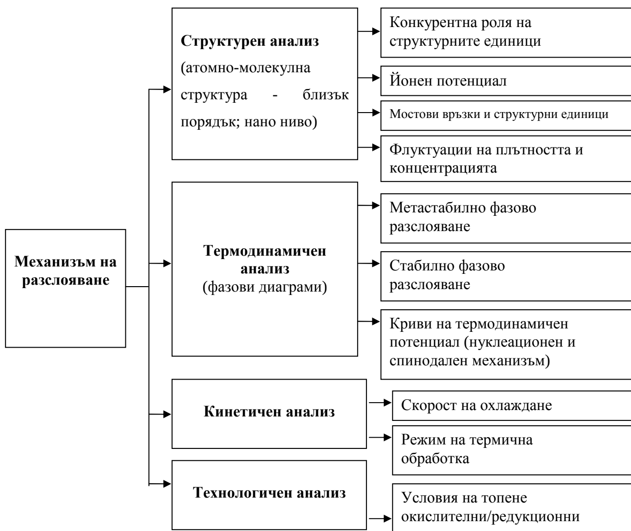
Фигура 47. Механизъм на разслояването на основата на структурни, термодинамични и кинетични критерии
