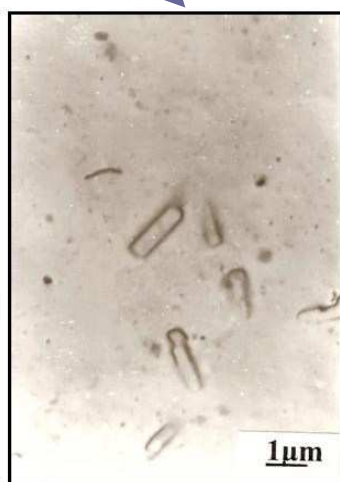
Фигура 34. ТЕМ микрографии на: а) горен слой на образец със състав 60\text{B}_2\text{O}_3.10\text{MoO}_3.30\text{CoO} , б) долен слой; в) образец със състав 30\text{B}_2\text{O}_3.10\text{MoO}_3.60\text{CoO}
