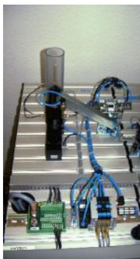
Фиг.3.2: Изглед на FESTO станция за разпределяне на детайли
