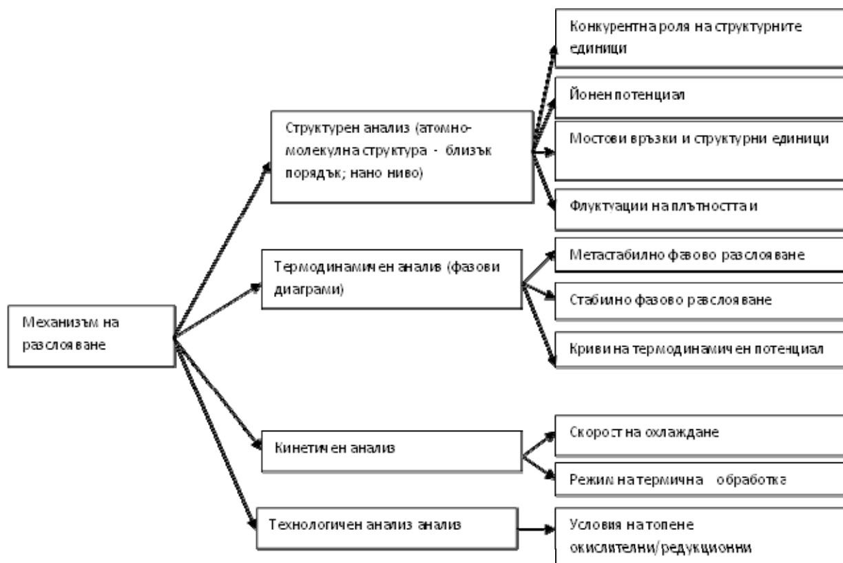
Фигура 6-1. Схема за анализ на течнофазовото разслояване в изследваните многокомпонентни моделни стъкла за имобилизация на ВАО.
