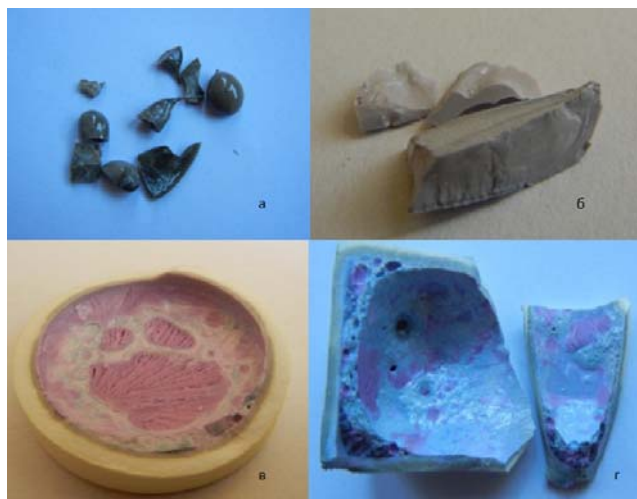
Фигура 4-2. Преход от микро към макро течно-фазово разслояване с увеличаване на процентното съдържание \text{MoO}_3 в изследваните образци: а) 15 тег. % \text{MoO}_3 , б) 20 тег. % \text{MoO}_3 , в) 25 тег. % \text{MoO}_3 , г) 80 тег. % \text{MoO}_3
