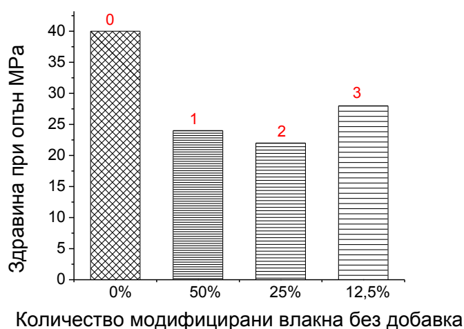
Фиг. 44 Здравина при опън в зависимост от количеството модифицирани влакна без добавка
