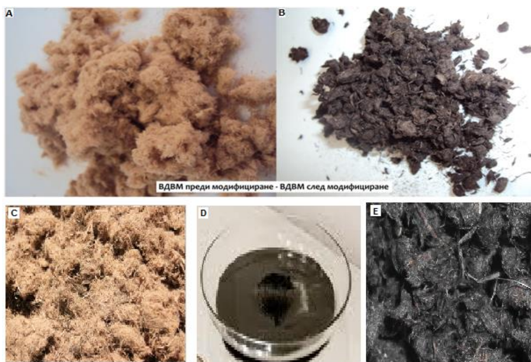
Фиг. 33 (А) – ВДВМ преди модификация, (В) – ВДВМ след модификация 1-ви метод, (С) – ВДВМ преди модификация, (D) – суспензия на магнетит, (Е) – ВДВМ след модификация 2-ри метод.
