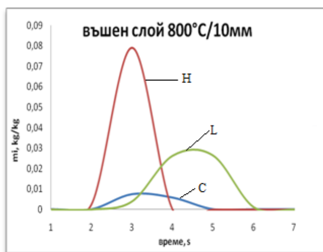
Фиг. 4.10. Скоростта на възникване на твърдия въглероден остатък на повърхността на частицата
