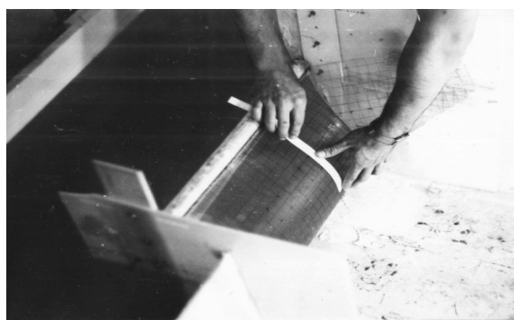
Фиг. 2.3. Лабораторен експеримент за определяне на механичните свойства и формообразуването на носещата мембрана при хидростатично налягане
