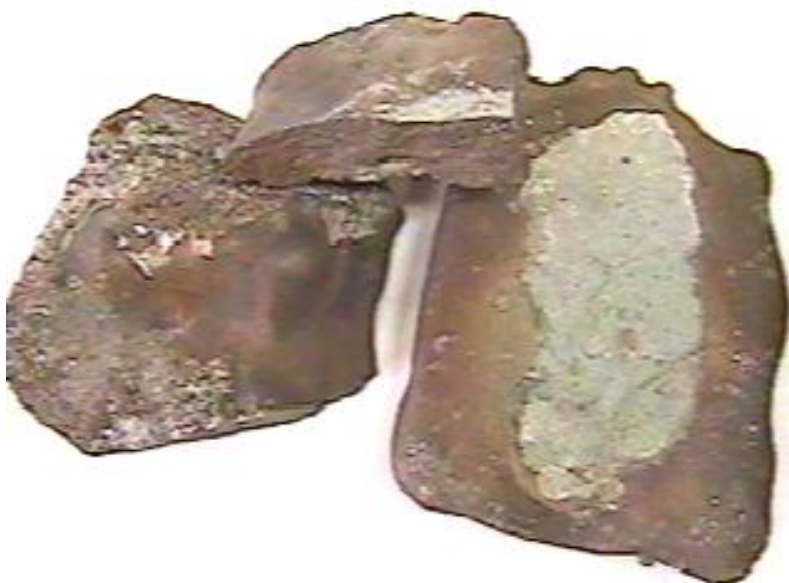
Фиг. 17. Късове Si-Mn-V феросплав получена по електроалумотермичен метод.
