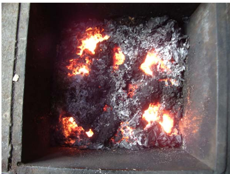
Фигура 8. Агломерационно горене на шихта с 70 % концентрат и 30 % катализатор и образуване горен агломерационен слой
