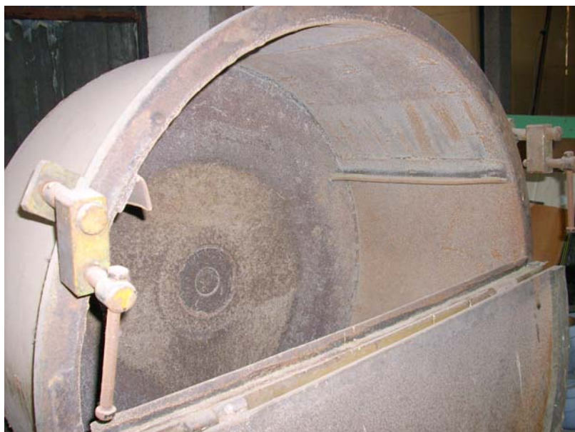
Фигура 4. Топков барабан за смилане на катализатора и концентрата преди тяхното агломериране
