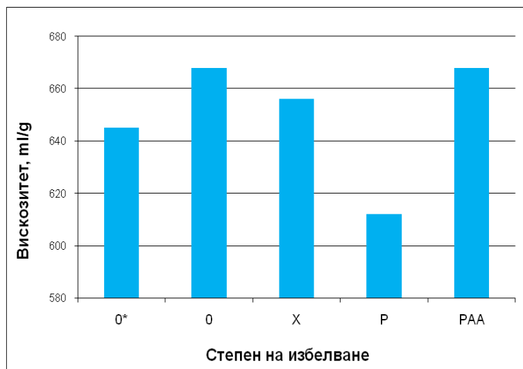
Фиг. 39. Изменение на вискозитета на целулозата вследствие от ензимното, пероксидното и пероцетно третиране на целулозата, *оптимални условия на избелване за всяка степен и разход на реагент 0.20%
