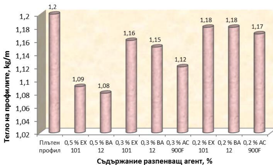
Фиг.41 Изменение на теглото на профилите в зависимост от вида и количеството разпенващ агент
