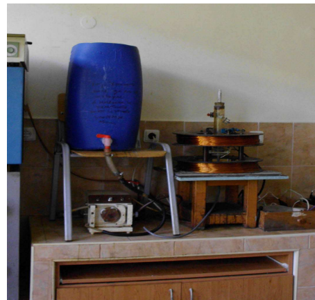
Фиг. 5.2. Реален изглед на експерименталната инсталация, използвана за цементация на метали в магнитно-контролирани слоеве
