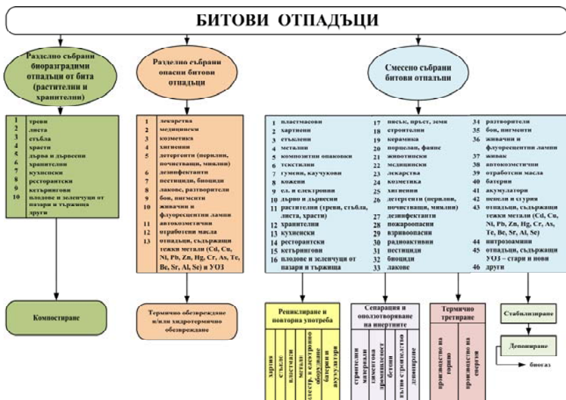
Фиг. 4.3.-1. Принцилна схема на предлаганото разделно събиране на биоразградимите и опасните отпадъци от бита
