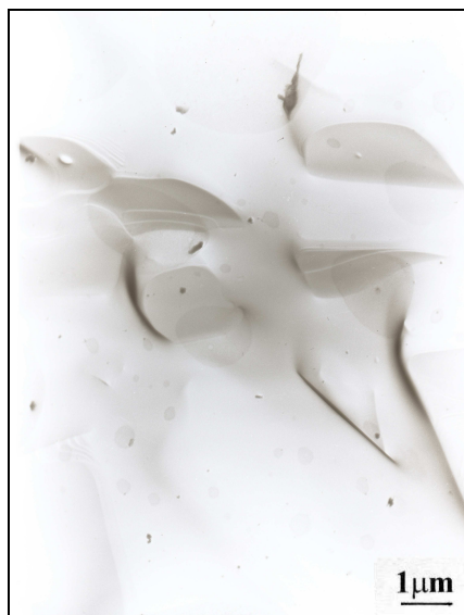
Фиг. 23. ТЕМ микрофотография на спечен образец със състав: 80мас. % гелно стъкло ( 2\text{PbO} \cdot \text{B}_2\text{O}_3 ), 20мас. % \text{PbMoO}_4 .
