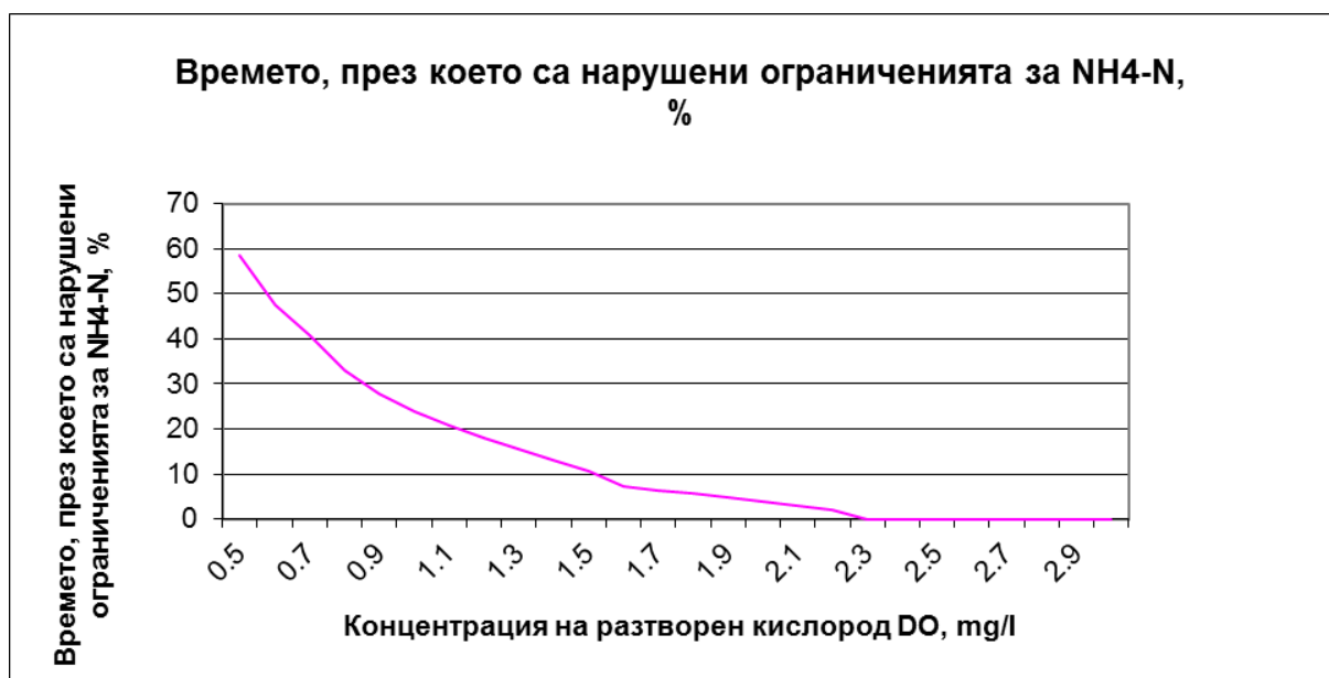
Фиг. 6.17 Времето през, което са нарушени ограниченията като функция на концентрацията на разтворен кислород
