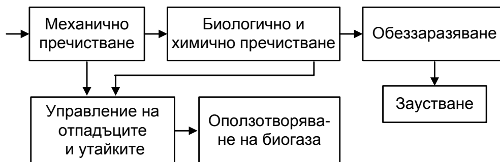
Фиг.5.1 Технологична схема на пречиствателна станция
